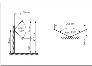
Pick-up angle of the camera module ACM 673-...
